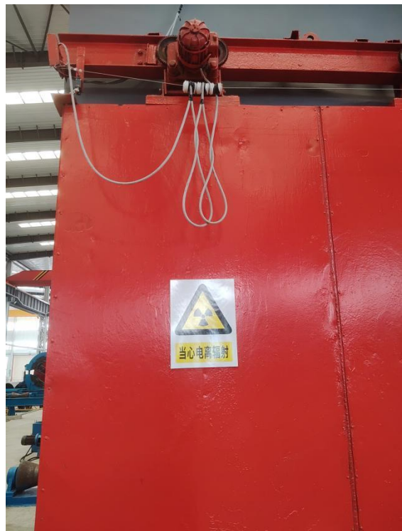
图 3-22 大管探伤室大防护门电离辐射警告标志
