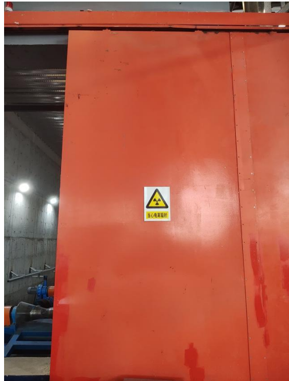
图 3-38 3620 管线探伤室电离辐射警告标志
