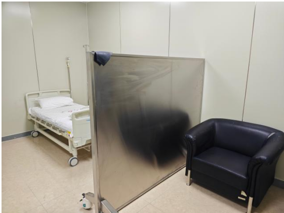
图 3-6 SPECT-CT 留观室内铅屏风
